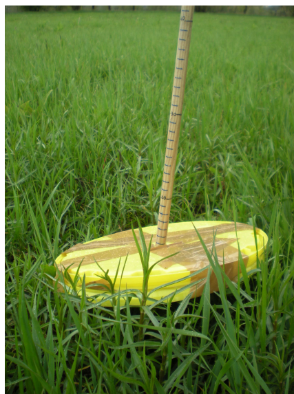
Figure 5 : Application de la méthode du disque-mètre dans une prairie. (Source : Bossard, 2012)
